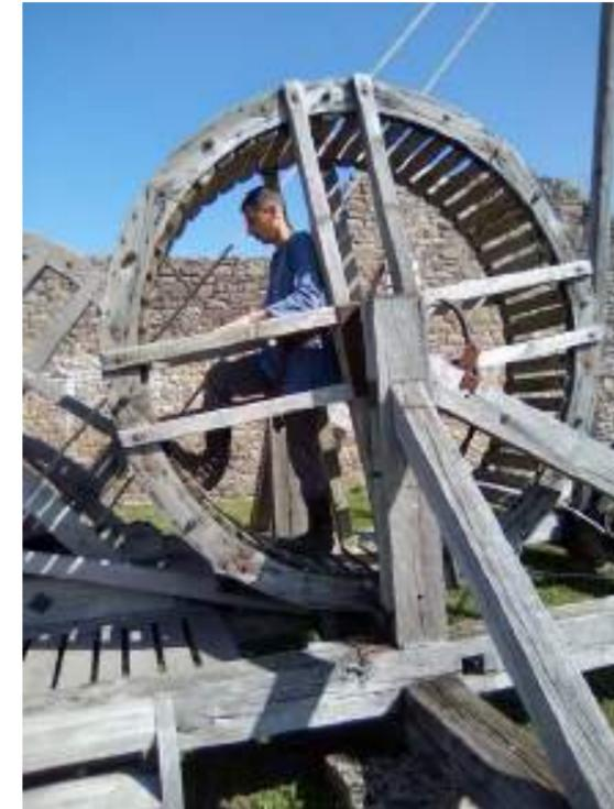
Cette roue est également appelée **roue de carrier** car elle était à l'origine utilisée
